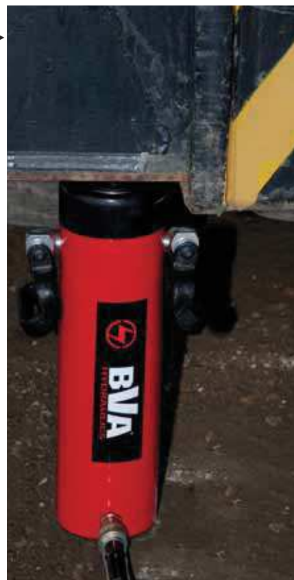
A H5513 egyszeres működésű munkahenger behúzza, emelésre készen
